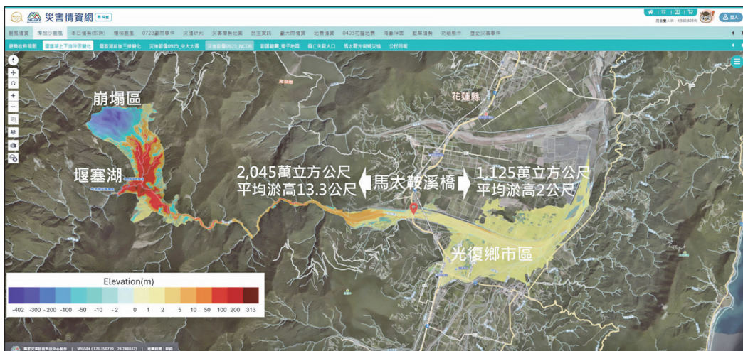
圖 7 馬太鞍溪災害事件上游至下游地形與土砂變化量
