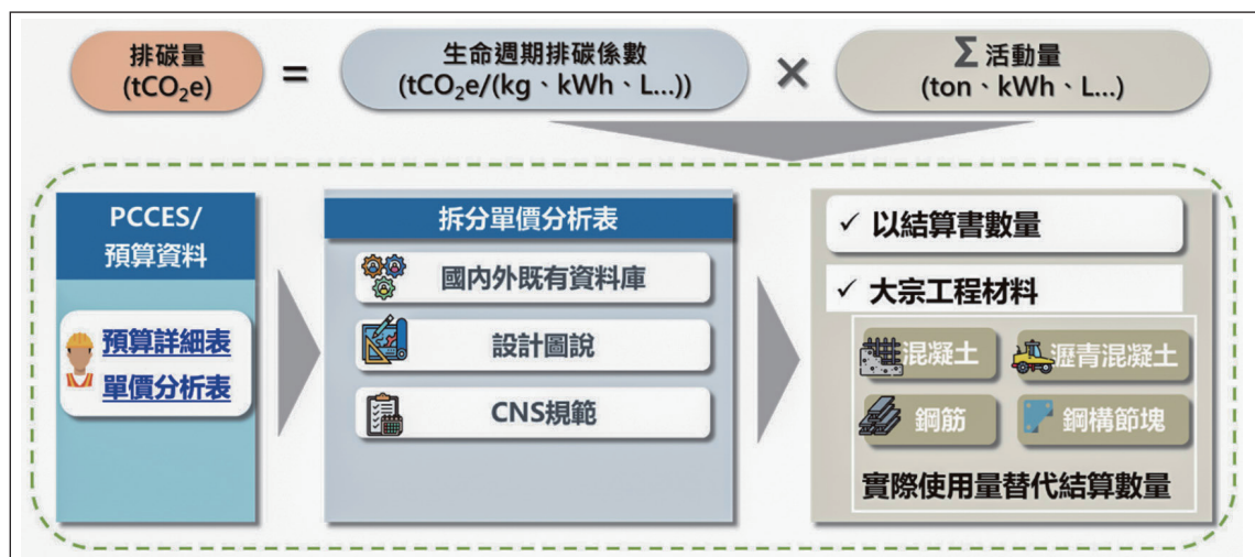
圖 2 PCCES 工程排碳量估算方式及流程
