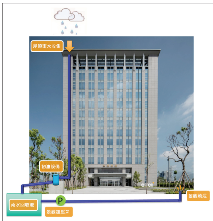
圖 2 中鼎集團第二總部大樓雨水回收示意圖
