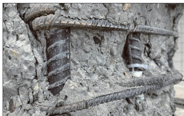
圖 3 北區國震中心進行 PLC 低碳混凝土耐震試驗
