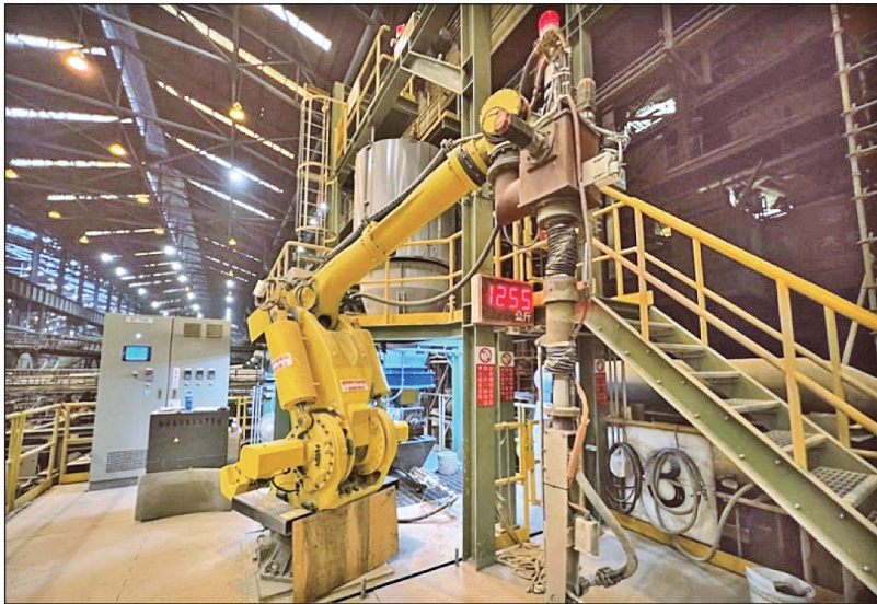
圖 9 耐火材料自動噴漿機
