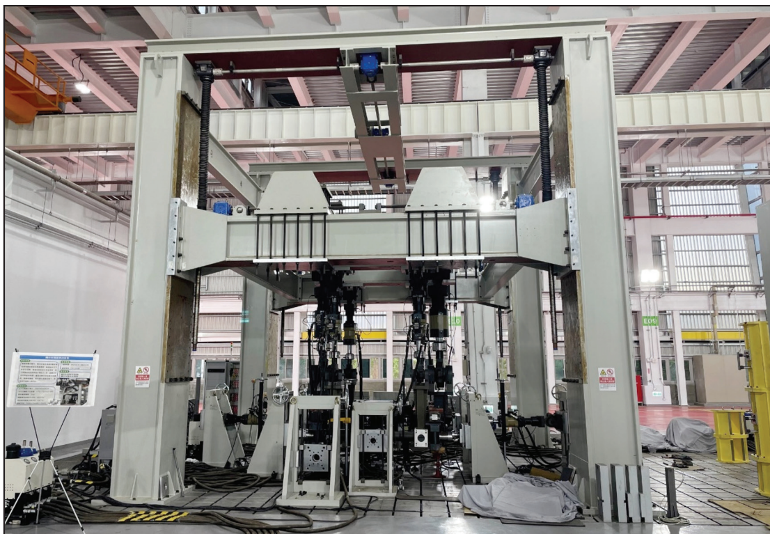
圖 4 轉向架負載測試設備 (鐵研中心)
