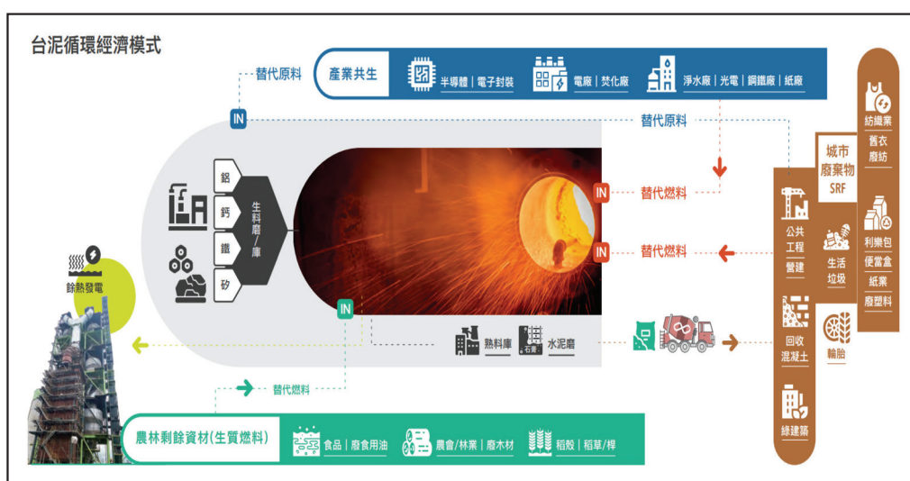
圖 8 台泥循環經濟模式於水泥製程中添加替代原燃料之示意圖
