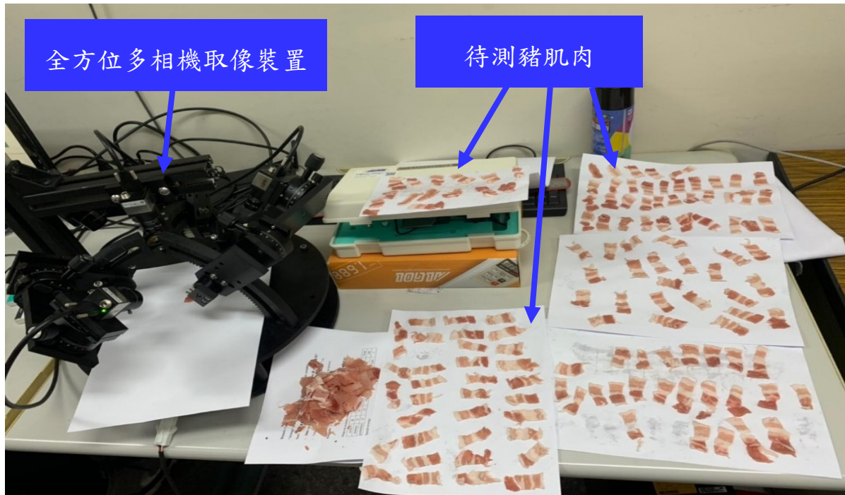
圖 14. 全方位多相機取像裝置拍攝待測豬肌肉實驗架設
