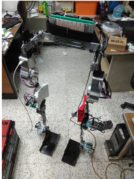
圖十三、第三代智慧穿戴式下肢外骨骼機器人實驗環境
