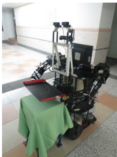
圖五、以雙眼視覺辨識及對餐盤定位之智慧型移動式機器人
