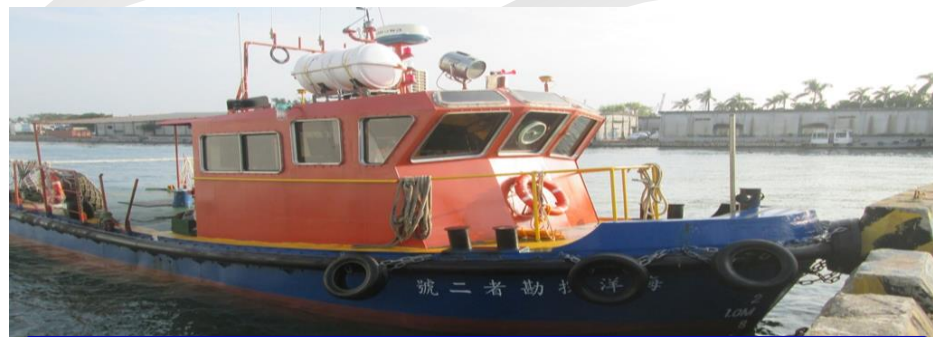
測量工作船：海洋探勘者2號(台籍)，配備多音束 測深儀、姿態儀、聲速剖面儀等
