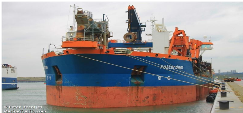
鹿特丹號浚挖船、2001年、船長186m、船寬31m 雙耙吸式、浚挖深度93公尺、泥艙21,665m 3
