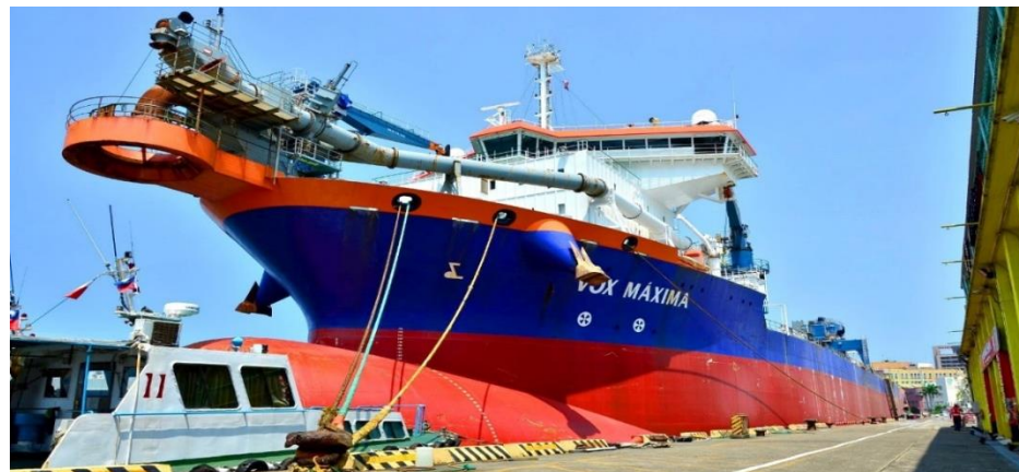
麥西瑪號浚挖船、2009年、船長203m、船寬31m 單耙吸式、浚挖深度125公尺、泥艙31,387m 3
