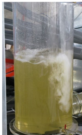
無擋板 射流速度約15.1 m/sec
