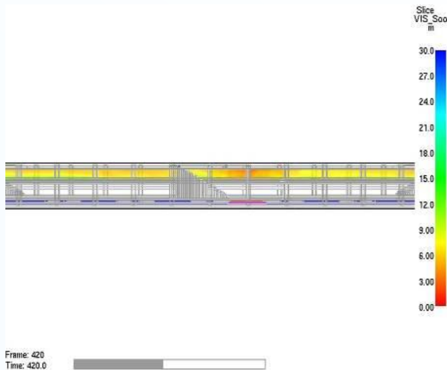
高雄車站列車中間發生30 MW火災之 能見度長向剖面圖（360秒）
