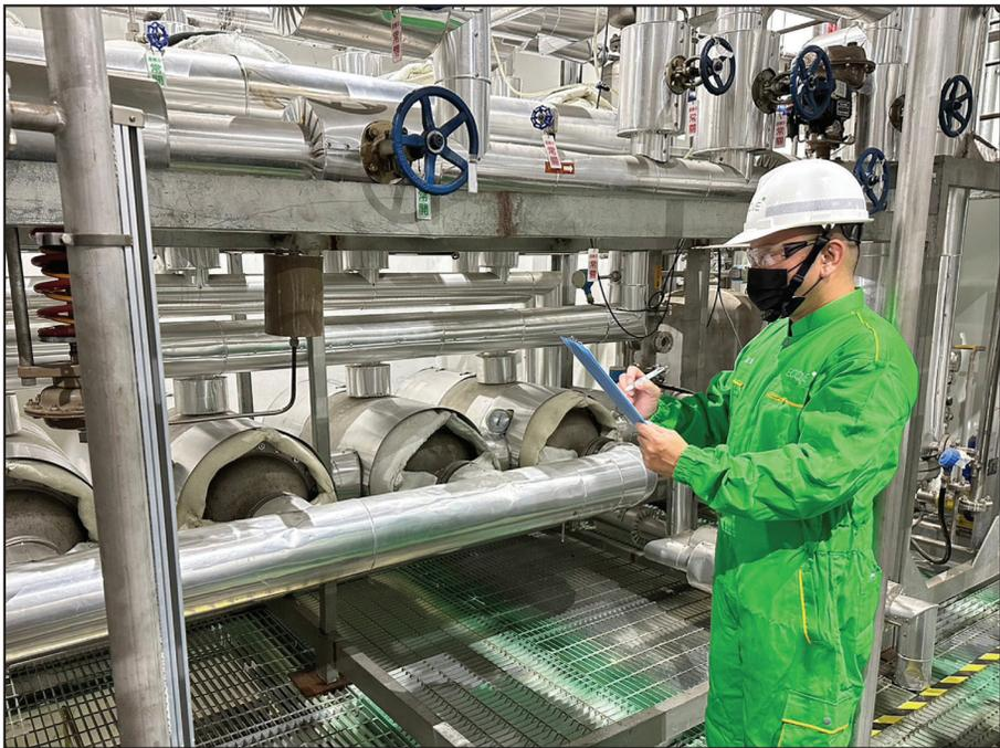
圖 7 蒸汽滲透膜系統
