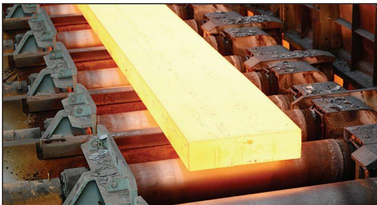
圖 2 國內常見的連續製程 2: 鋼鐵加工 (資料來源: 中鋼集團官方網站)
