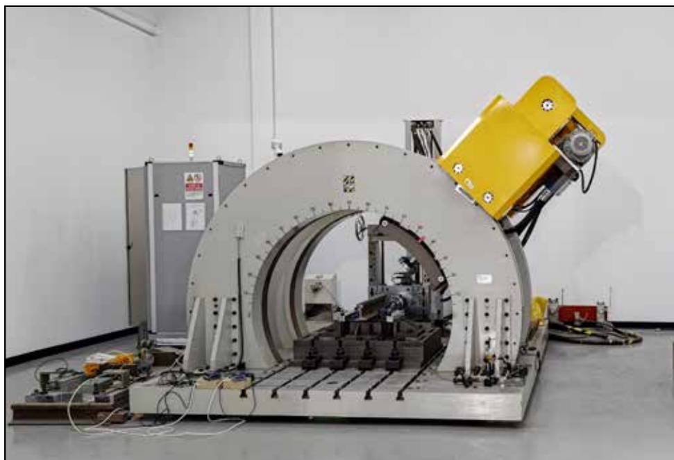
圖 7 軌道複合基鈑負載與疲勞測試設備 (鐵研中心)
