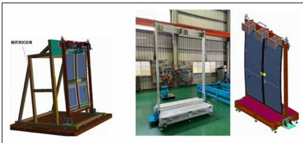
圖 38 乘客支撐力測試治具設計圖及完成品
