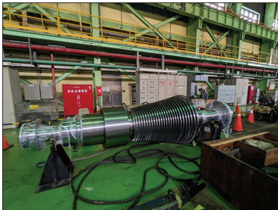
圖 33 新高壓汽機轉子待安裝
