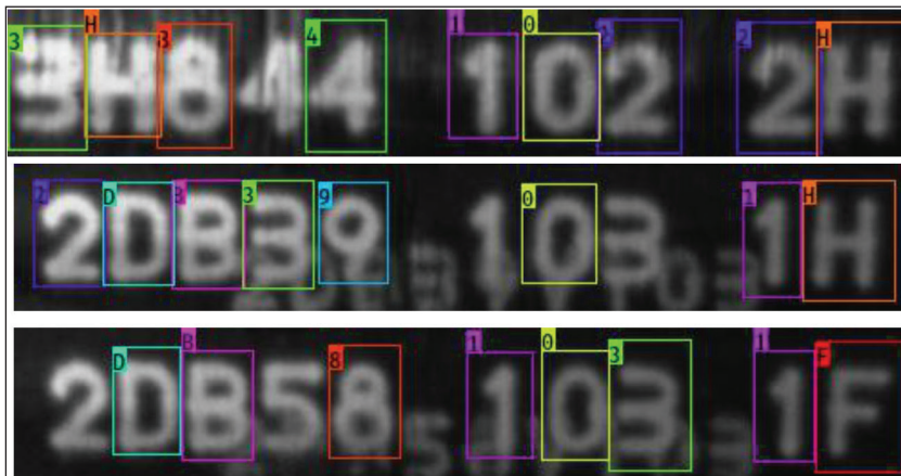
圖 3 相同模型對不同鋼胚上的字元偵測差異
