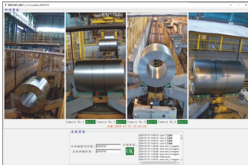
圖 10 產線鋼品識別系統實際畫面
