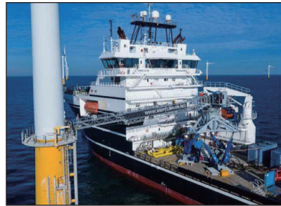
圖 11 Walk-to-Work 系統（來源： https://www.ampelmann.nl/ ）
