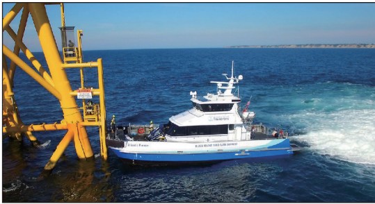
圖 10 人員運輸船靠泊方式（來源： https://www.atlanticwindtransfers.com/ ）
