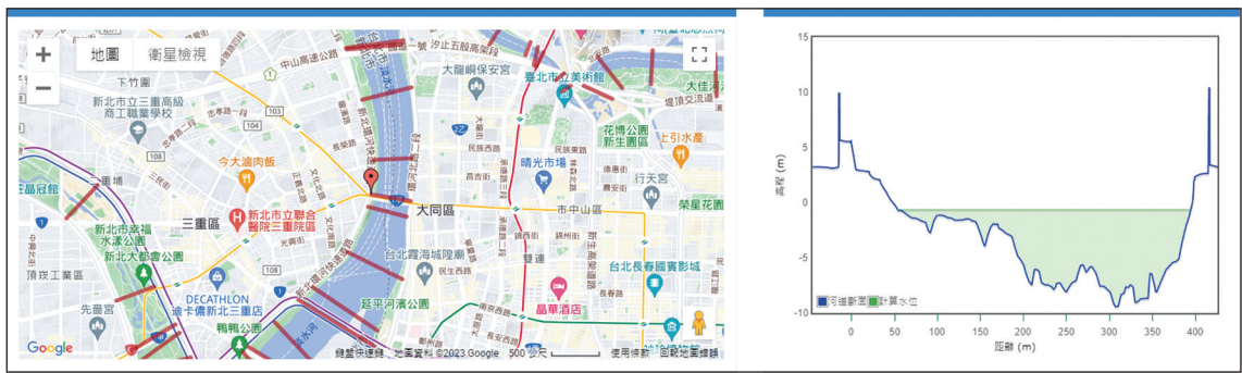
圖 6 圖左河道上的連線為淡水河大斷面分布示意圖。圖右為臺北橋河川橫斷面圖, 橫軸為左岸到右岸距離, 縱軸為高程, 藍線為河川斷面, 淺綠色塊代表河川水位在斷面的位置
