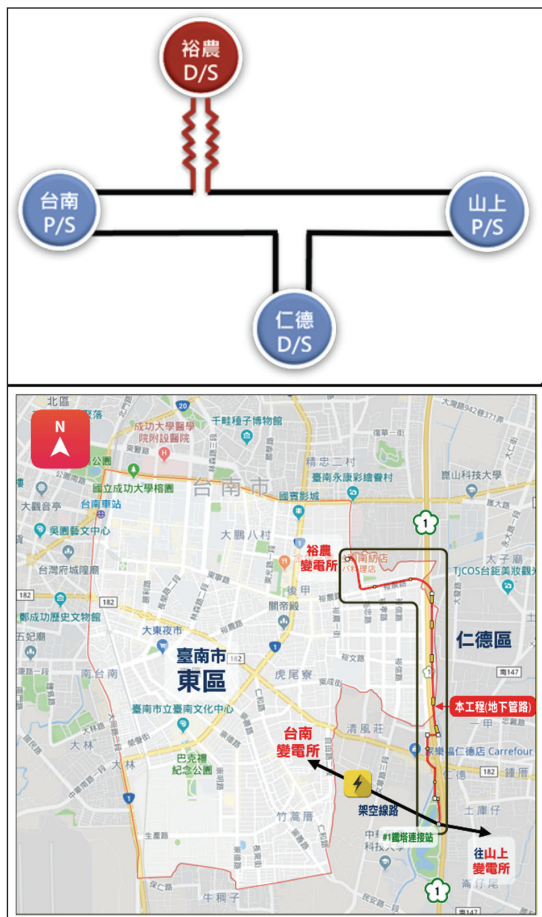
圖 14 台南一進一出裕農線路工程
