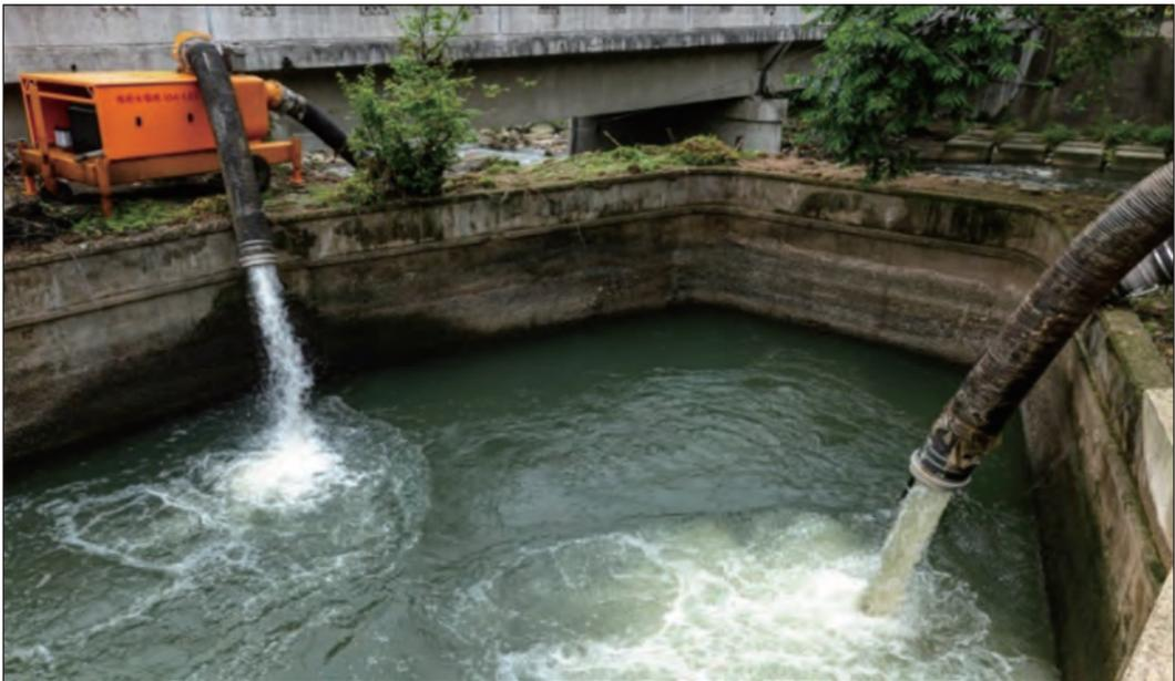
圖 6 支援桃3灌區移動式抽水機抽水情形
