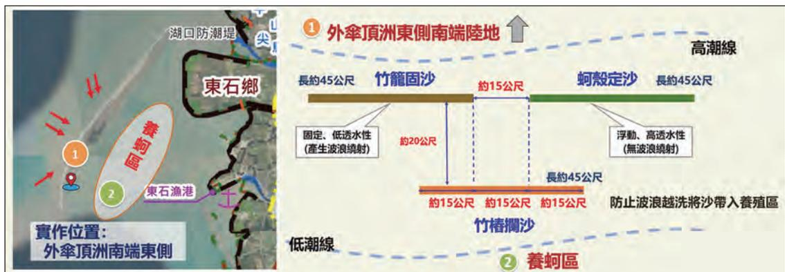
圖 7 3種沙洲攔沙工以倒「品」字型排列方式布置
