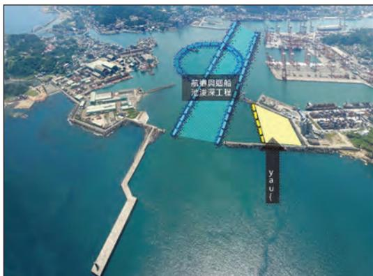
圖1 基隆港土方收容填區圍堤造地工程平面配置圖
