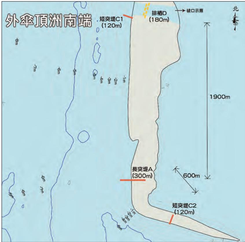
圖 14 外傘頂洲南端滯沙工程位置圖
