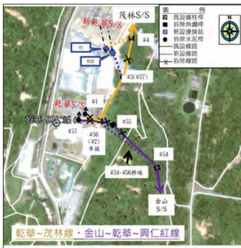
圖 20 第二階段改接配置圖
