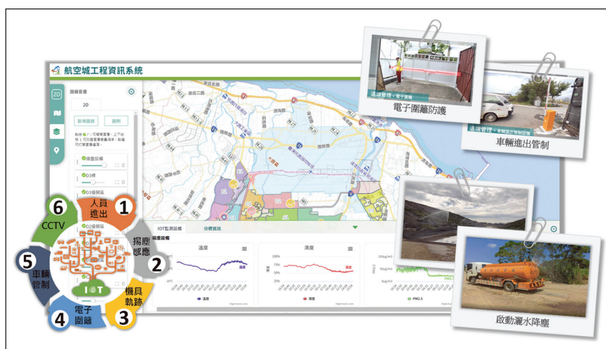
圖 4 整合 IoT 設備資訊達成遠端管理
