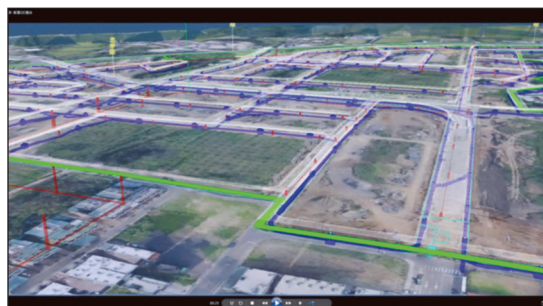
圖 24 3D 實景模型整合地下管線 BIM 模型
