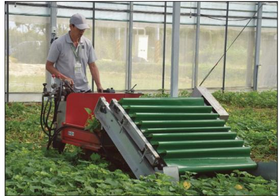
圖 13 電動式葉菜散裝收穫機
