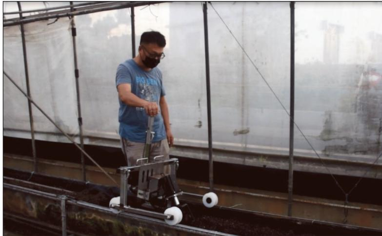
圖 16 槽耕電動鬆土機及其操作方式
