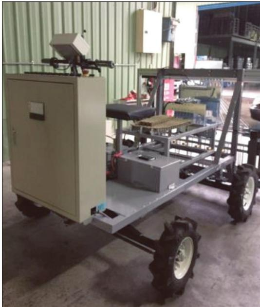
圖 12 電動式紙穴盤菜苗移植機
