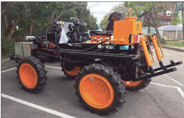
圖 15 電動式設施葉菜栽培管理機
