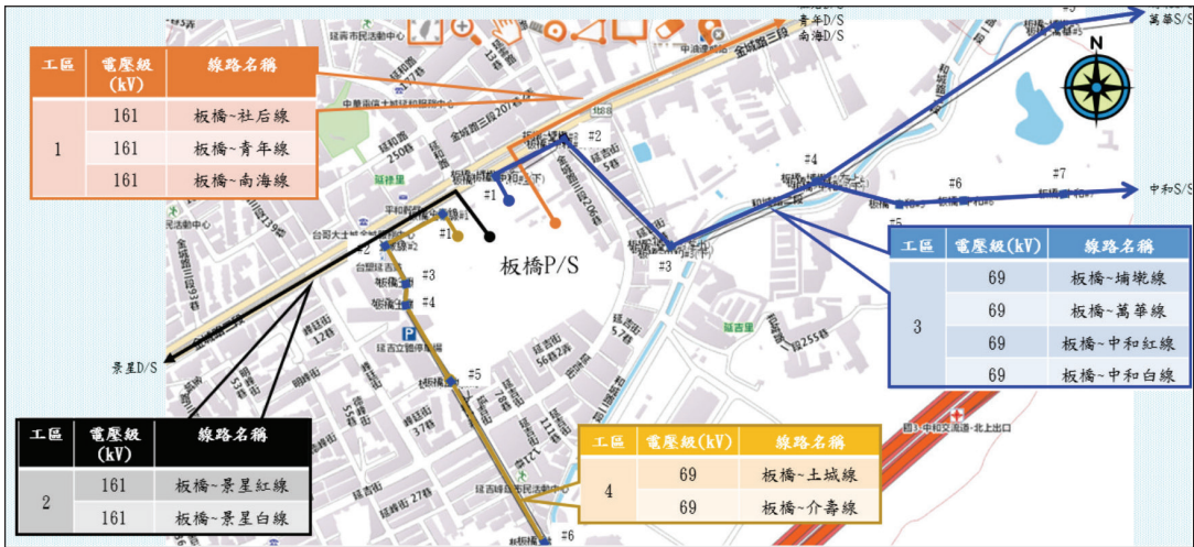
圖 16 板橋 P/S 161、69kV 線路原配置
