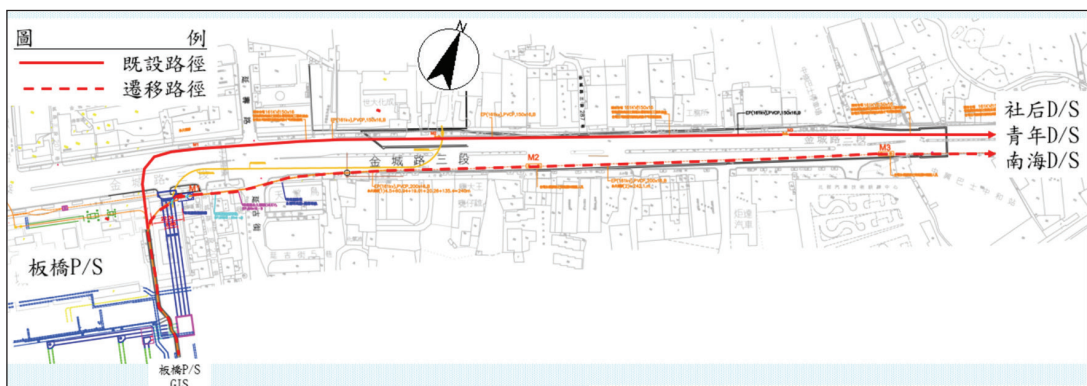
圖 17 第 1 階段板橋 P/S~M6 電纜遷移工程
