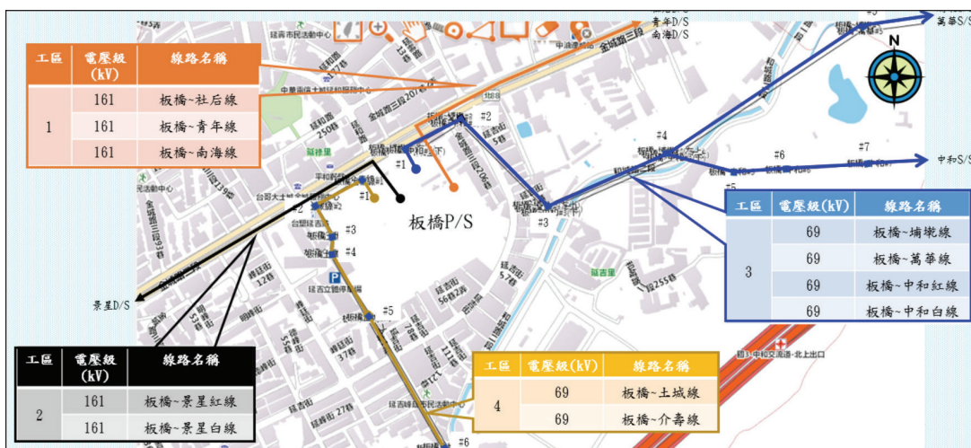
圖 16 板橋 P/S 161、69kV 線路原配置
