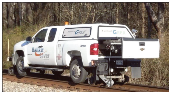
圖 28 石碴分佈檢測儀於路軌兩用車輛配置情形 [4]
