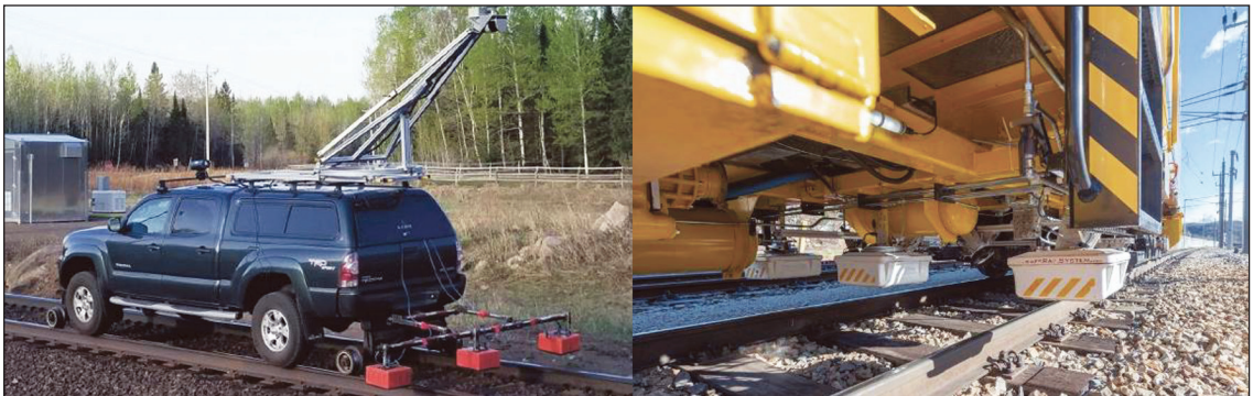
圖 25 軌道全斷面檢測儀於路軌兩用車與鐵路車輛配置情形 [2, 4]
