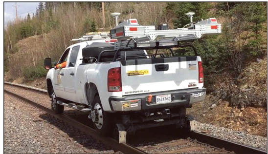
圖 31 軌道構件健康度檢測儀於路軌兩用車輛配置情形 [5]
