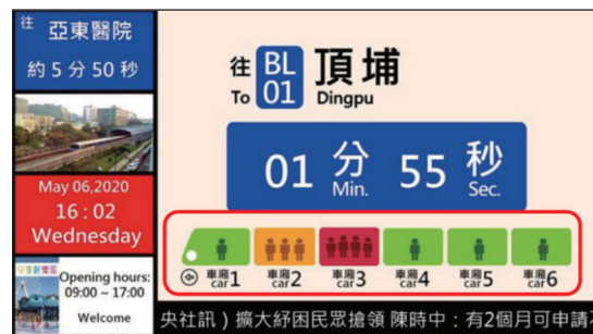
圖 15 月台電子看板顯示車廂擁擠度
