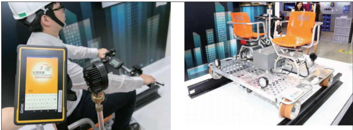
圖 2 台灣高鐵 - 軌道智慧化電動巡檢機車
