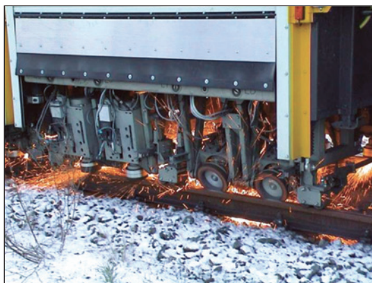
圖 17 研磨中的研磨模組 [10]
