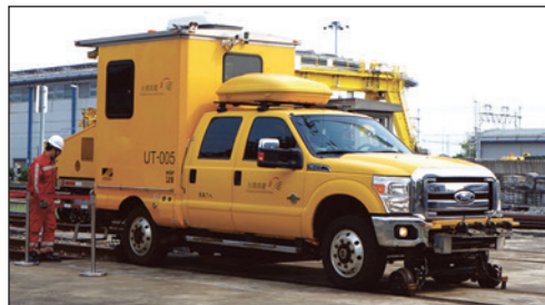
圖 11 台灣高鐵路軌兩用鋼軌超音波探傷車 [9]
