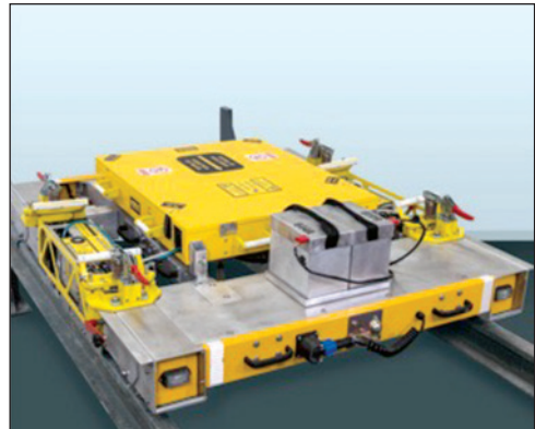
圖 10 車載式軌道表面裂紋測量系統 [8]
