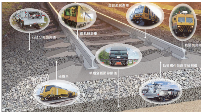
圖 5 智慧化軌道養路工程車與設備型態 [1-5]
