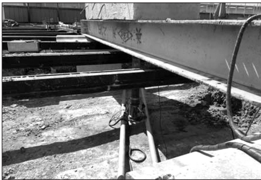
圖 16 路基平板載重試驗
