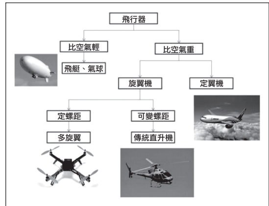
圖 4 無人飛行器構型分類 [5]
