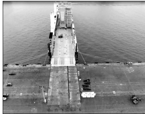
圖 15 臨時橋板置於港口岸邊並與重件船銜接之情形
