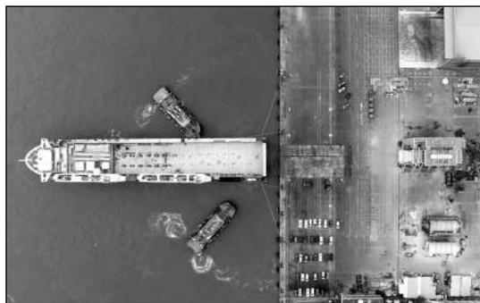
圖 10 兩艘拖船協助重件船尾靠示意圖
