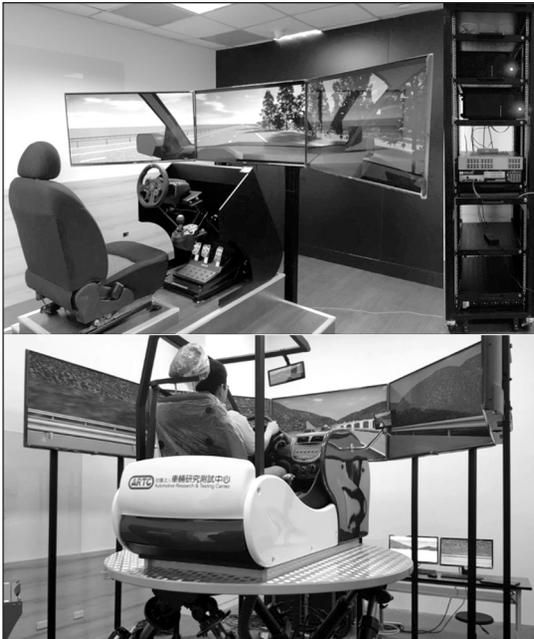
圖 14 靜態 (上) / 動態 (下) 駕駛模擬器設備
