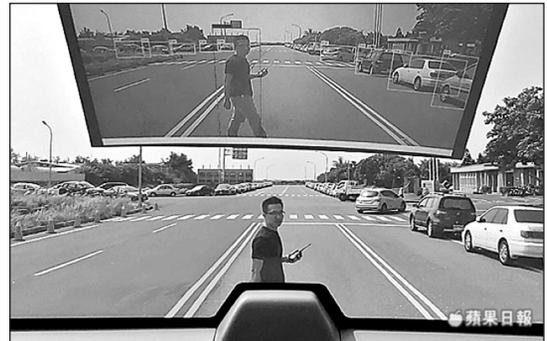
圖 25 行人闖入啟動自動緊急煞車
