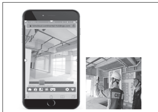
圖10 大陸工程之工地現場以手機讀取資訊模型現況
