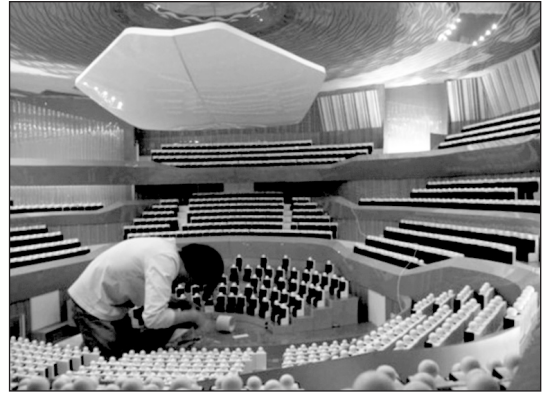
圖6 音樂廳 1:10 聲學縮尺模型。圖 / 徐亞英提供
