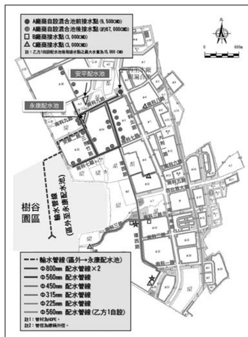
圖6 臺南園區再生水配水管網示意圖
