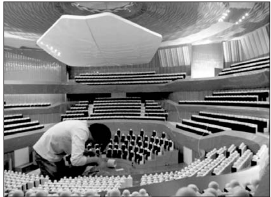
圖6 音樂廳 1:10 聲學縮尺模型。圖 / 徐亞英提供
