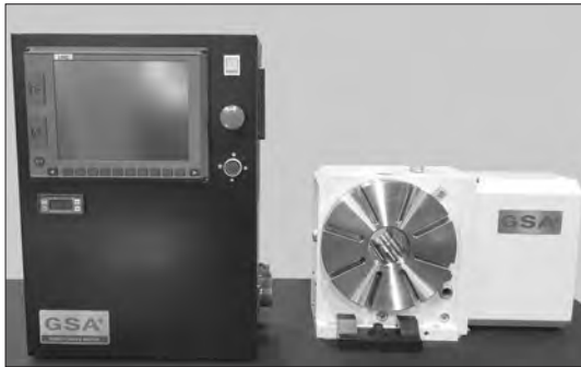
圖 4 LNC SMB 與旭陽分度盤的整合
