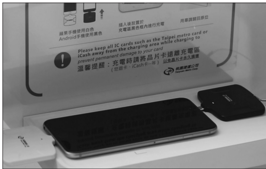
圖 3 機場捷運車廂無線充電座
