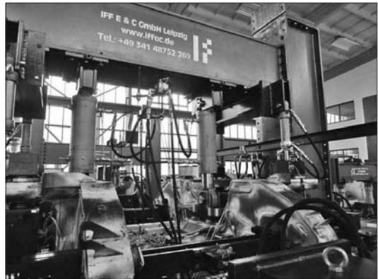
圖 14 轉向架框疲勞測試
