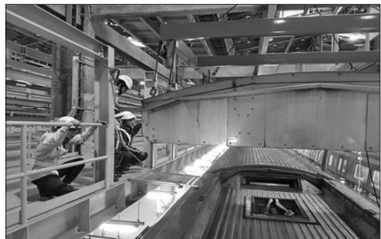
圖 8 電聯車軸承組裝及檢查
