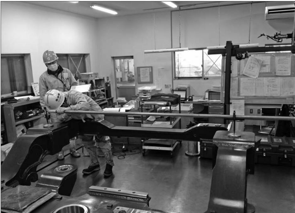
圖 5 轉向架框尺寸量測作業
