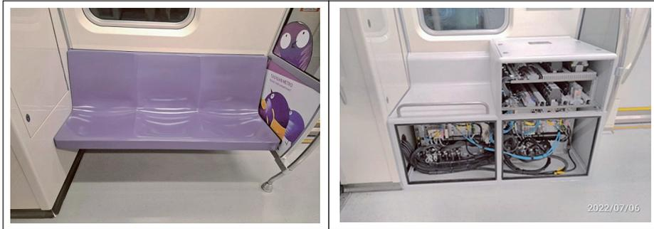
圖 3 列車控制單元 (OBCU, OnBoard Control Units)
