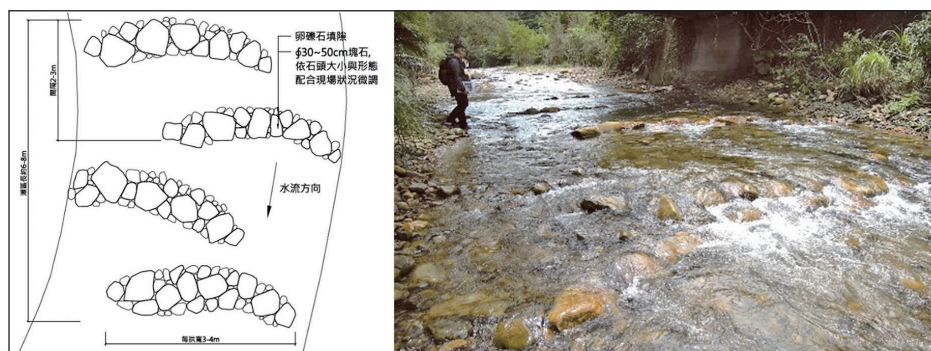
圖 18 填排法瀨區平面圖（左）及完工後（右）
