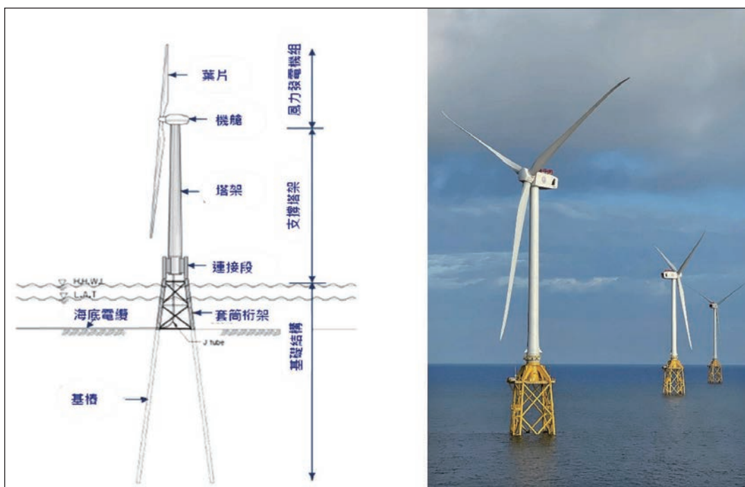
圖 3 風機下部結構示意圖（照片出處：台電公司提供）
