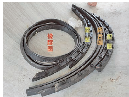
圖 10 DIP-U2 型推進管之接頭構件
