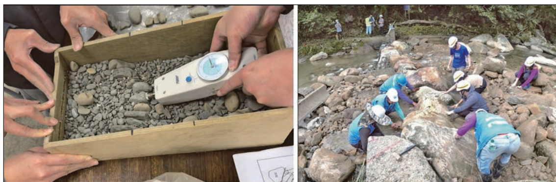
圖 20 近自然工法室內砂箱推力測試（左）及室外一堰改造實作（右）
