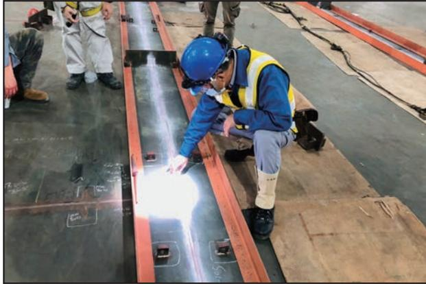
圖3 儲槽內槽底板銲道加強滲透液檢驗(PT)檢驗，品管人員拿放大鏡檢視顯像全白
