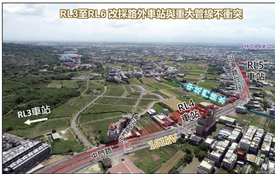
圖 27 小港林園線 RL3~RL6 路段石化管線處置規劃
