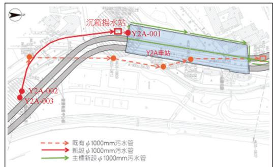
圖 8 Y2A 站污水管推進平面位置圖
