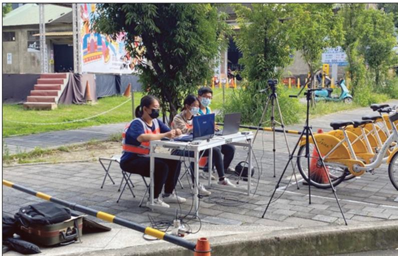
圖 6 背景噪音與振動現地量測照片
