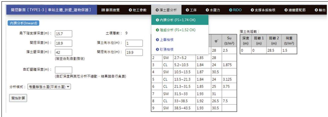
圖 11 SinoExcavation 平台擋土壁體穩定性檢核 (內擠、隆起、上舉、砂湧)
