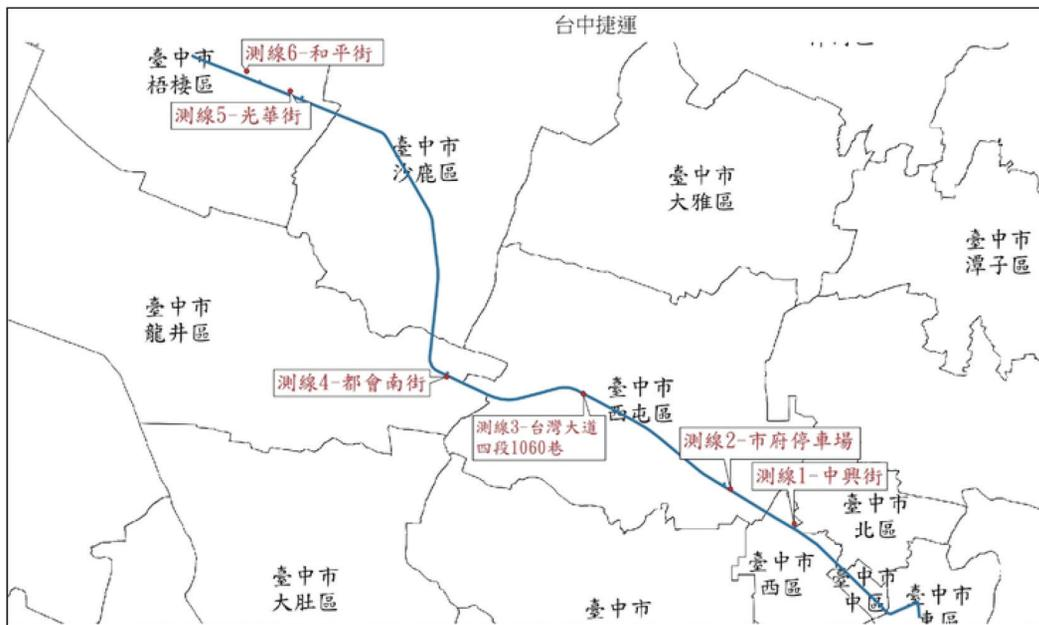
圖 3 捷運藍線沿線主要地質材料地層傳遞動性量測測線分布圖
