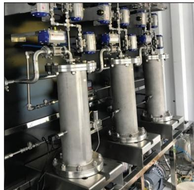
圖 6 三塔式真空變壓吸附裝置
