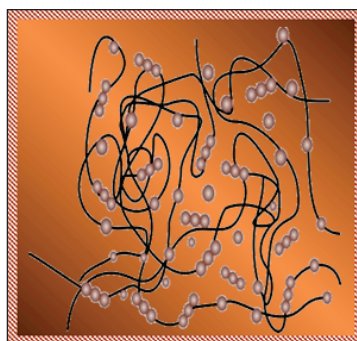
圖 6 高分子型膠 / 固態電解質結構示意
