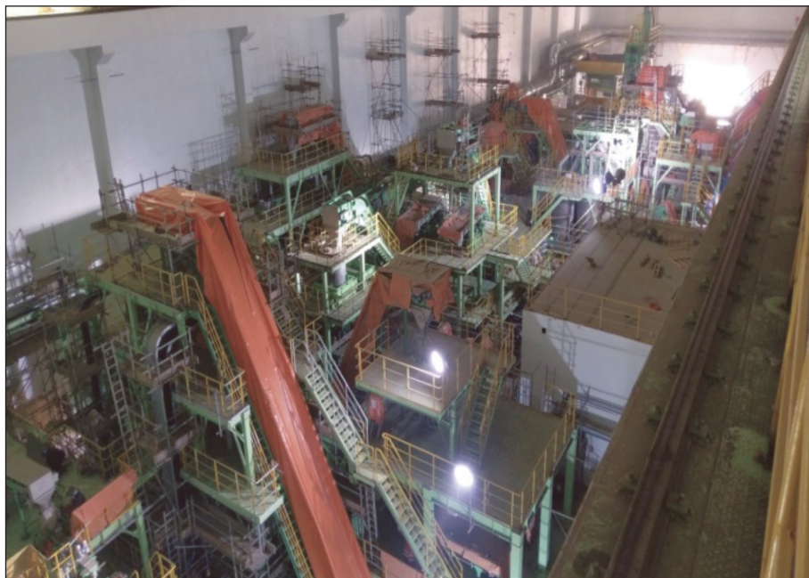
圖 6 大角度爬昇輸送機可有效縮減空間，為現代輸送製程新趨勢
