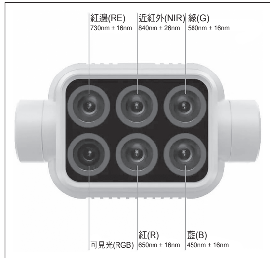
圖 12 DJI Phantom 的多光譜相機
