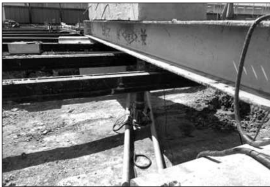
圖 16 路基平板載重試驗
