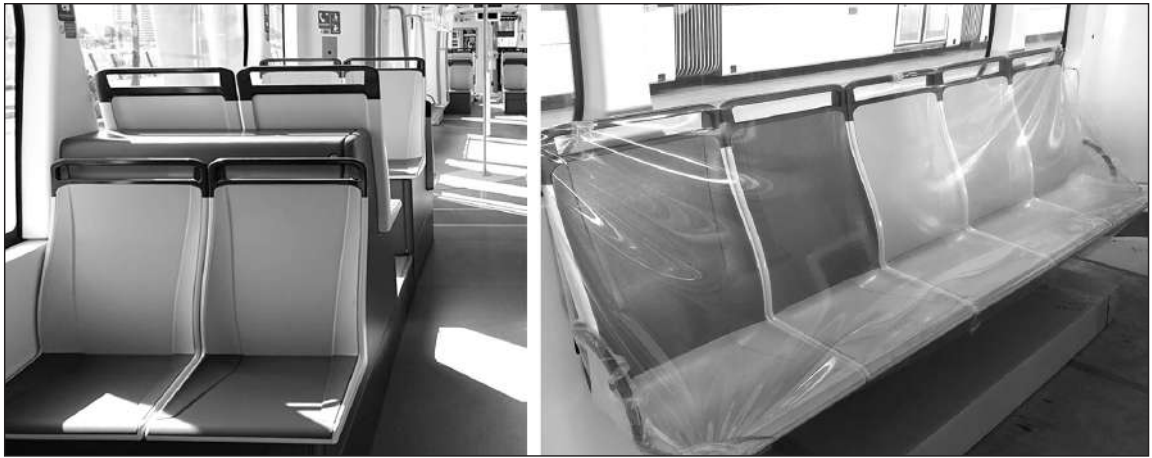
圖 6 淡海、安坑輕軌國產化高強度塑膠材質座椅
