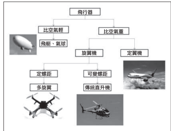
圖 4 無人飛行器構型分類 [5]
