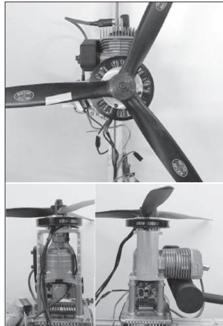
圖 19 引擎同軸發電機組裝三視圖
