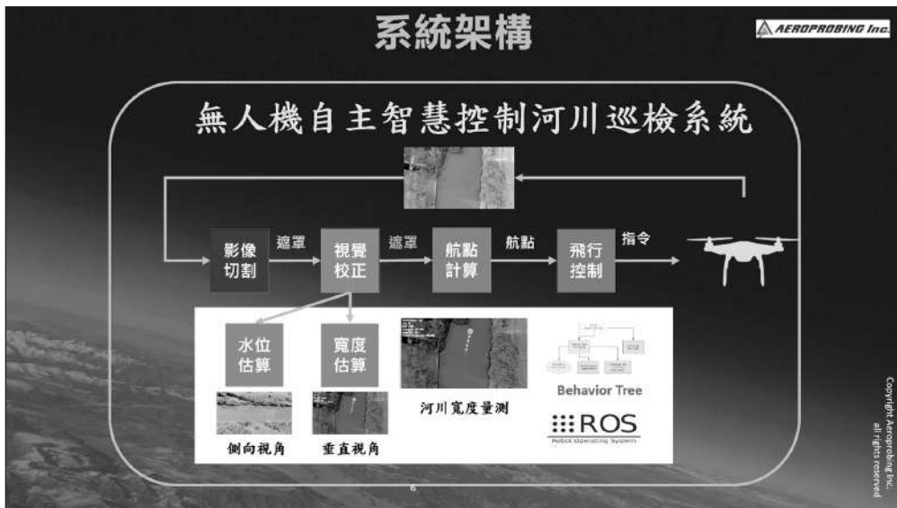
圖 9 具備邊緣運算能力的河川巡檢無人機系統架構
