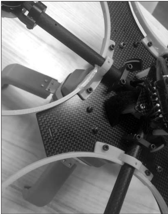
圖2 室內無人機消毒系統之碳纖維框架及設計。來源：本文撰稿整理。
