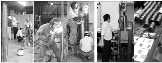
圖 15 程序檢定及機械性能測試過程
